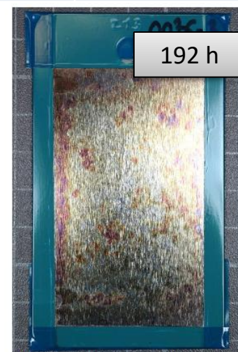
Abbildung 6: Q-Panels Nr.3 nach 192h im NSS
