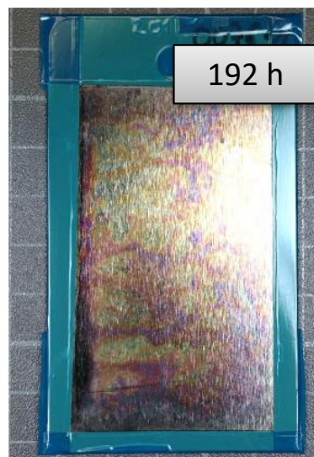
Abbildung 2: Q-Panels Nr.1 nach 192h im NSS
